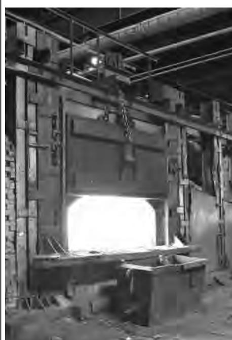
**Проведен капитальный ремонт томильной зоны методической печи №2 обжимного крупносортного стана «1150», которая обеспечивает качественный нагрев слитков перед прокатом.**
