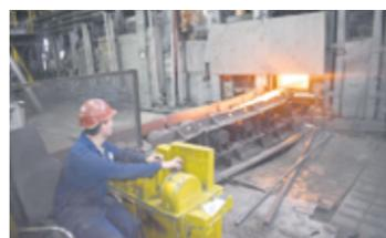
Методическая печь стана «400» получила техническое обновление. Агрегат остановили на капитальный ремонт 24 июля. 8 августа агрегат возобновил работу и начал выдавать продукцию в соответствии с производственным заданием.
